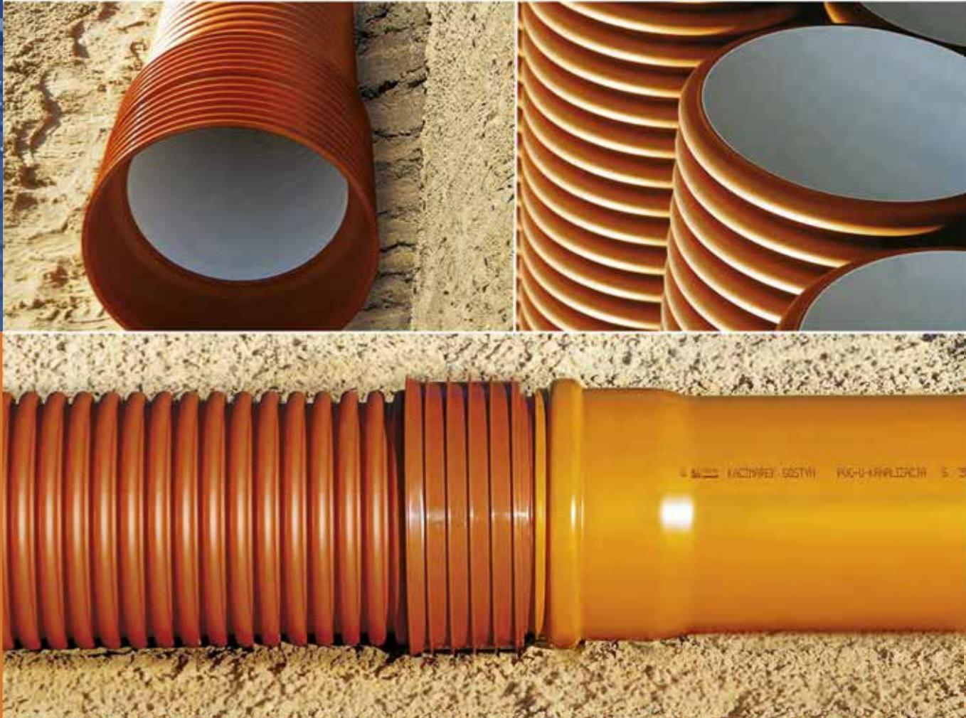
Forskellen på angivelsen af indvendige mål (DN/ID) og det udvendige mål (DN/OD) er betydelig. Som det fremgår af sammenligningen herunder, er der f.eks. stor forskel på rørenes kapacitet alt efter om diameteren oplyses som DN/ID 400 (indvendig) eller DN/OD 400 (udvendig).
