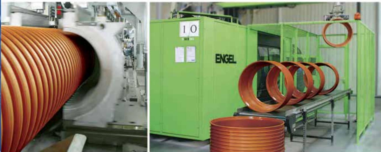
**K2-Kan** fremstilles ved at to uafhængige snegleskruesystemer former PP granulatet. Den indvendige overflade er helt glat og sikrer uhindret flow. Udvendigt er røret korruget, hvilket sikrer høj holdbarhed og ringstivhed. Denne kombination kombinerer fordelene ved lav vægt, gode styrkeegenskaber og markant reducering af materialeomkostninger. Rør med korrugerede vægge og samme ringstivhed som rør med massive vægge er op til 65% lettere.
