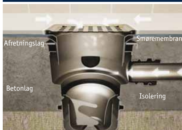
Beton og fliser med smøremembran
